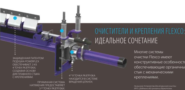
Многие системы очистки Flexco имеют конструктивные особенности, обеспечивающие органичный стык с механическими креплениями.
