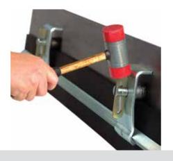
Легким ударом резинового молотка стопорный палец извлекается на время регулировки или замены резинового фартука, и таким же легким ударом устанавливается на место.
